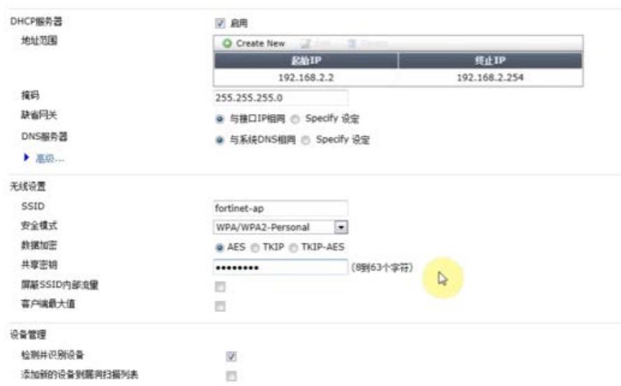
图 5：新建 SSID 配置界面
