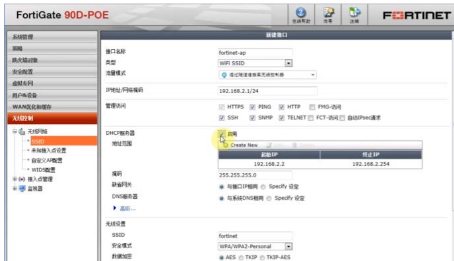
图 4：新建 SSID 配置界面
